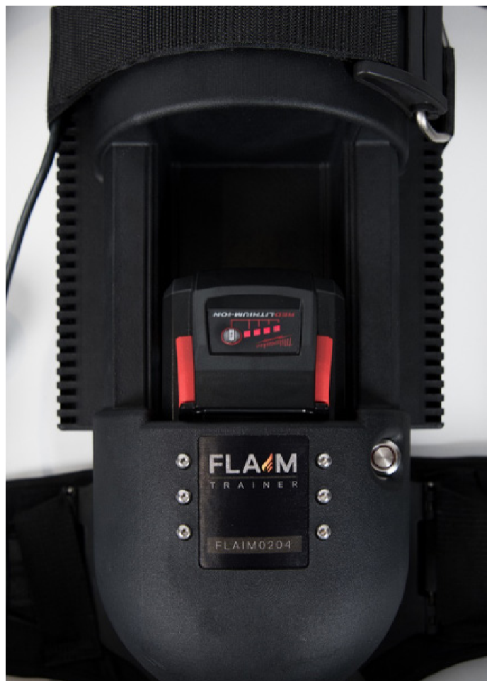
Figur 12: Batteri tilsluttet og fastgjort
