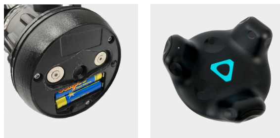
Figur 15: Dysens front med visning af installerede batterier og tracking-puck
